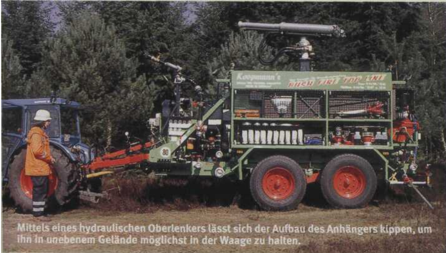
Vier Strahler dienen als Umfeldbeleuchtung. Da der Anhänger kein Feuerwehrfahrzeug ist, durfte Koopmann keine blauen Kennleuchten verwenden. Er entschied sich für grüne. Der Regner mit dem Schutzbügel gehört zur Selbstschutzanlage.
