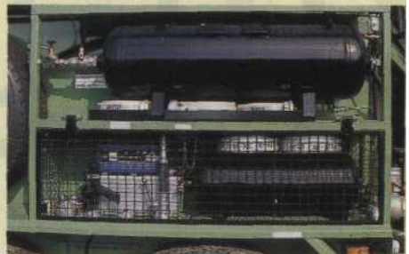
Der obere Druckkessel ist der Vorratsbehälter für die IFEX-Anlage. Darunter lagern Strahlrohre sowie eine eigene Fahrzeugbatterie mit Ladegerät.
