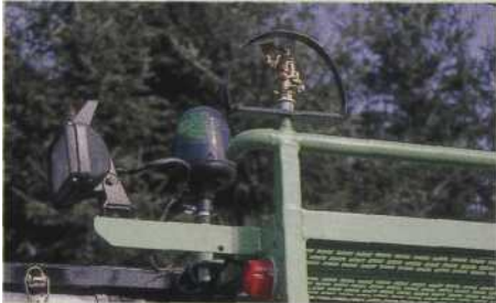
Vier Strahler dienen als Umfeldbeleuchtung. Da der Anhänger kein Feuerwehrfahrzeug ist, durfte Koopmann keine blauen Kennleuchten verwenden. Er entschied sich für grüne. Der Regner mit dem Schutzbügel gehört zur Selbstschutzanlage.
